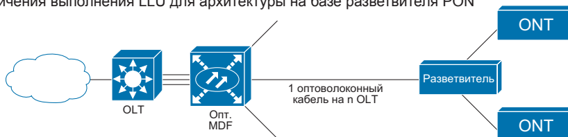
Рисунок 7. Оптоволоконная линия с оптическим распределительным узлом для выполнения требований LLU
